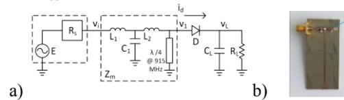
Fig. 1. Designed rectifier: a) circuit diagram, b) fabricated prototype.
